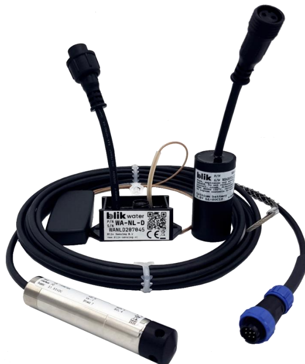
Figuur 1: in het midden de WA-NL-F node met de antenne daar links van. Rechts daarvan een WA-BP-LC battery pack, en vooraan een WA-PB-16 peillood.
